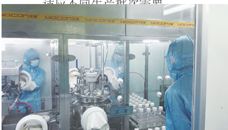
全自动无菌灌装系统， 小时产能500瓶，完全不需人工干预。
